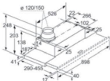
Tiefenanpassung des Filterauszuges bis 29 mm möglich
